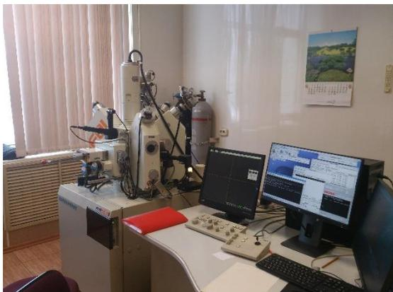
Fig.1 電子顕微鏡 JXA-8100
